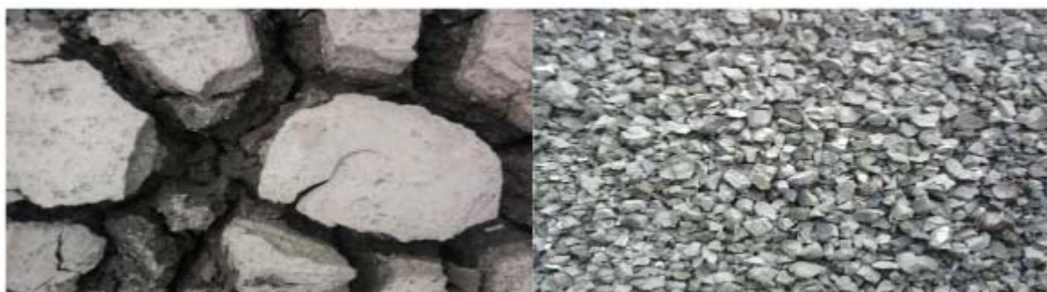
Рис.12.2.1. Изменение структуры осадка в процессе обезвоживания на площадке подсушивания
