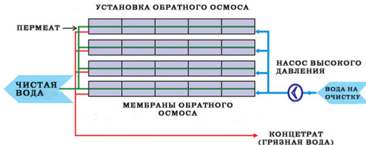
Рис.10.13.3. Принцип работы установки обратного осмоса.
