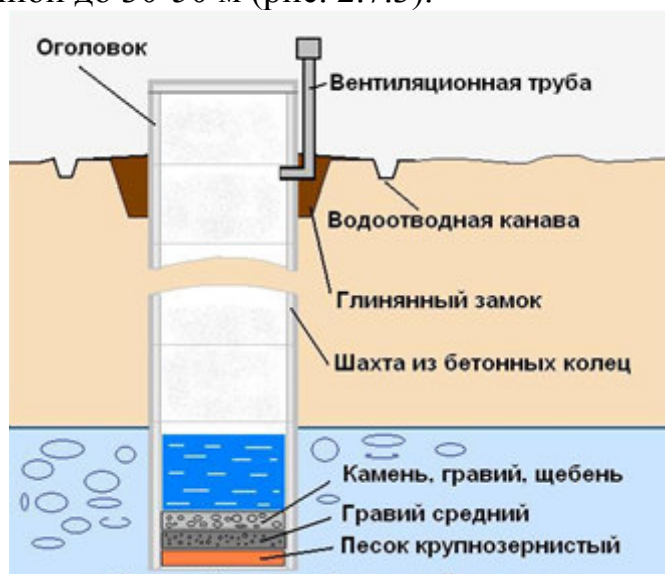
Рис.2.7.3. Сборный железобетонный колодец.
