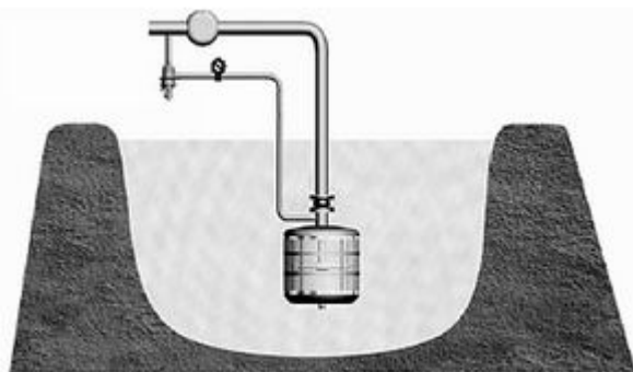
Рис.10.1.3. Установка преднасосного фильтра на водозаборе.
