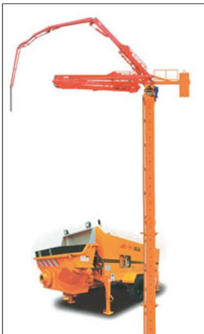
Появление современного бетонного оборудования открыло перед строителями принципиально новые возможности доставки бетона как по высоте (до 400 м), так и по дальности (до 2 км)
