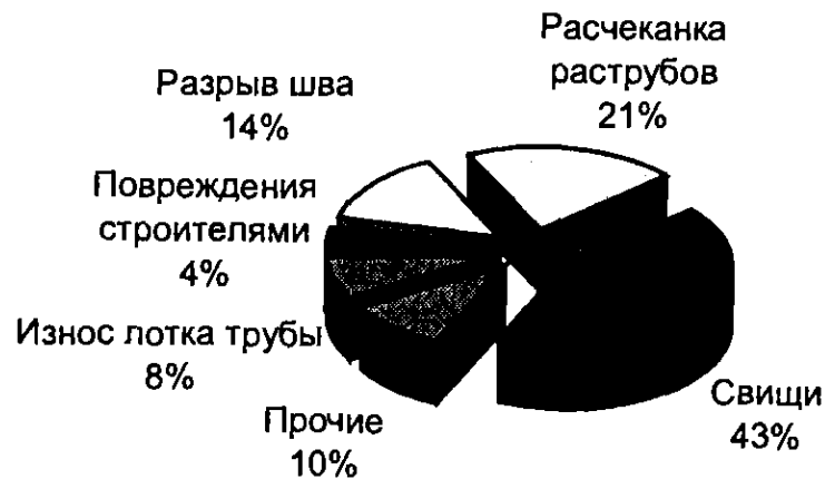
Рис. 21.2. Основные причины отказов напорных трубопроводов
