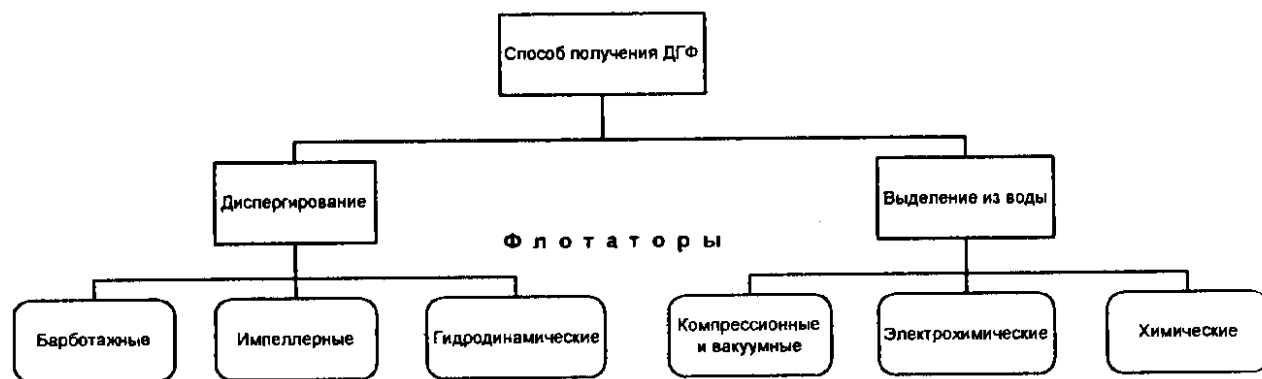
Рис. 13.1. Классификация флотационных сооружений по способу получения ДГФ
